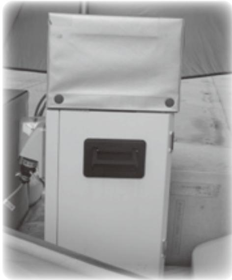
可動式モニタリングポスト（放射能測定器）
