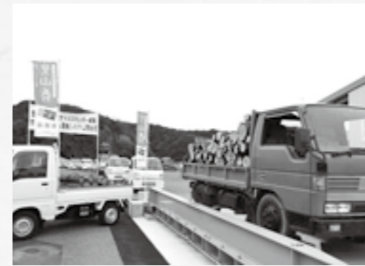
トラックスケールによる計量の様子
