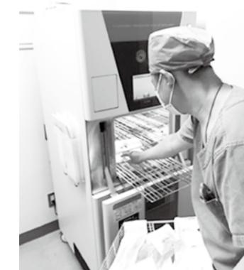
▲過酸化水素低温滅菌器により滅菌を行う様子
