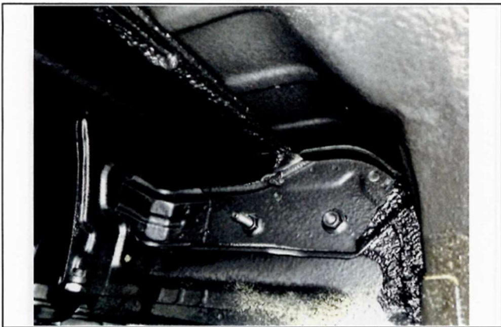
塗装完了後（後方部）
