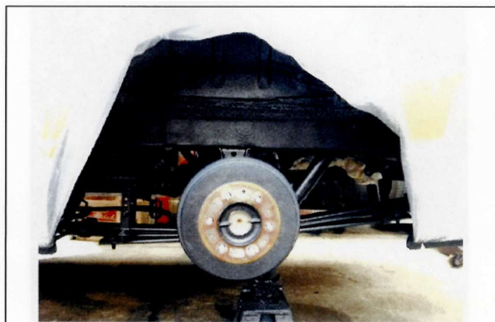
塗装完了後（左デフ・タイヤハウス部分）
