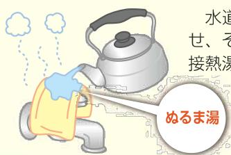
水道管が凍結したときは、凍った部分にタオルをかぶせ、その上からぬるま湯をゆっくりかけてください。直接熱湯をかけると破裂する恐れがあります。
