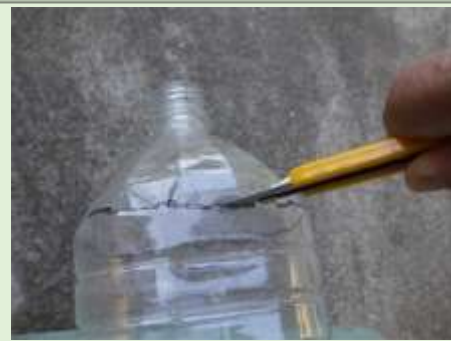
④入れた線に沿ってカッターナイフで切断する
