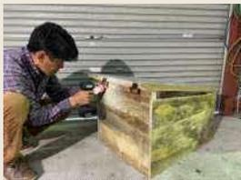
扉の幅を振り分けて後面に蝶番を取り付け固定します。
