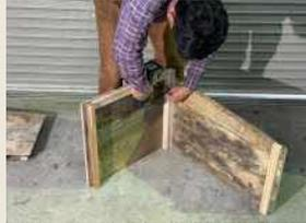
側面と後面を3本のビスで固定します。後面パネルは、横棧を上になります。3カ所の下穴からビスで固定します。
