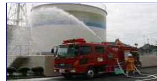
▲油火災にも対応できる化学消防車
