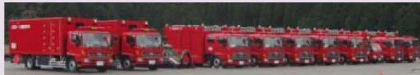
送水車, 水中ポンプ車, ホース展張車等
