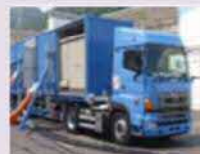
移動式代替 熱交換設備
