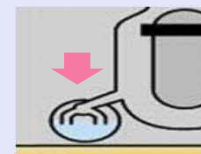
圧力抑制 プール
