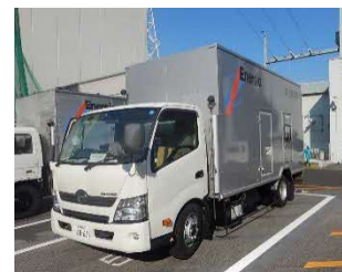
高圧発電機車
