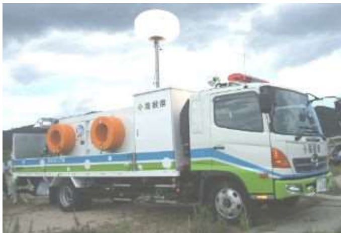
島根県所有の排水ポンプ車
