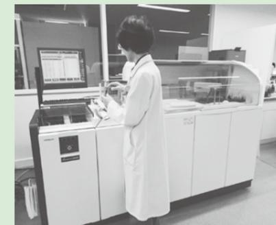
**尿分析装置**は、尿中の糖やタンパク、潜血などを測定します。試薬管理が簡便になり、装置や試薬の精度管理を毎日することでより正確な結果報告ができます。
