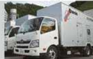
高圧発電機車
